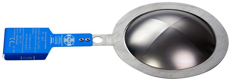
Domaines d'application : installations avec des gaz, des liquides ou des fluides multiphasiques. En raison de faibles tolérances à l'éclatement jusqu'à  $\pm 5\%$  et une plage de fonctionnement jusqu'à 90%, les disques de rupture de la série SZ-X sécurisent les installations avec de fortes charges permanentes. Le SZ-X se caractérise également par la propriété "Fail-Safe" : en cas de montage à l'envers, le disque éclatera toujours en dessous de sa valeur de rupture.
